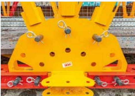
In Feldmitte der Binder sind nur 7 Passbolzenverbindungen notwendig, das reduziert zusätzlich den Montageaufwand und spart Gewicht.
