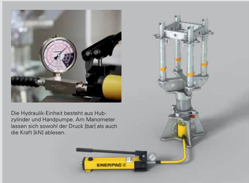
Die Hydraulik-Einheit besteht aus Hubzylinder und Handpumpe. Am Manometer lassen sich sowohl der Druck [bar] als auch die Kraft [kN] ablesen.
