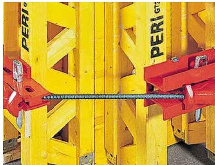
Der Träger an der Elementverbreiterung muss 2 cm überstehen, damit die Ecke fest vorgespannt werden kann.
