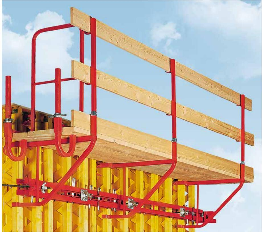
PERI Gerüstkonsole GB 80, zul. Nutzgewicht 1,5 kN/m<sup>2</sup>, max. Einflussbreite 1,25 m.
