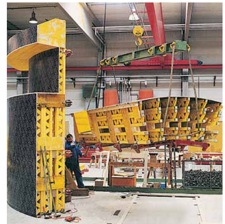
Auch komplizierte Querschnitte für Kläranlagen sind mit PERI GRV kein Problem.
