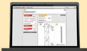
Das Tool ermöglicht die Auswahl von umfangreichen Konfigurationsvarianten für eine freistehende oder oben gehaltene Stützturmkonfiguration, diverse Kopfspindeltypen, die Berücksichtigung von Windeinwirkungen auf das Traggerüst und den Einsatz von Diagonalen. Nach Eingabe der Parameter
