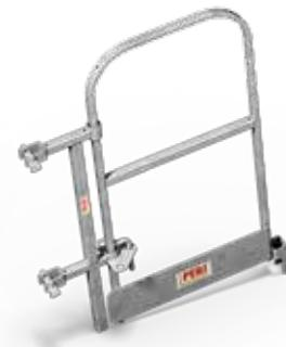
Das Stirngeländer MXK mit integriertem Bordbrett sichert die offene Kante der Arbeitsbühne quer zur Rahmenschalung. Es lässt sich in beide Richtungen um 90° schwenken, so dass der Durchgang zur nächsten Arbeitsbühne möglich ist.
