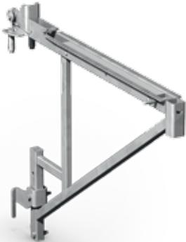
Die Gerüstkonsole MXK wird an den Streben der Rahmenschalung befestigt; sie dient als Auflager für die Gerüstbeläge MXK. Alternativ können auch Holzbohlen von oben aufgenagelt bzw. von unten angeschraubt werden.
