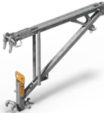
Die Gerüstkonsole MXK-RS bietet darüber hinaus die Möglichkeit eine Richtstütze direkt an der Konsole anzuschließen. Bei aufgestockten Elementen ist damit sichergestellt, dass die Richtstützen den Arbeitsbereich auf der Bühne nicht beeinträchtigen.
