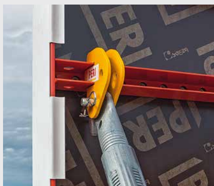
Der einfache Richtstützenanschluss LW für den Einsatz an stehenden Elementen lässt sich mit Bolzen und Federstecker an der Ankerstrebe befestigen.
