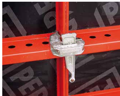
Das Detail zeigt die einfache Konstruktion der Bauteile sehr deutlich: Der schmale Flacheisenrahmen wird mit einem einfachen Keilschloss verbunden.
