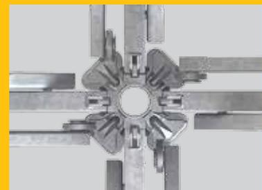
Der Knotenbereich bietet 12 Anschlussmöglichkeiten. Zusätzlich zu jeweils vier Horizontalriegeln und Knotendiagonalen lassen sich vier Riegeldiagonalen anschließen.
