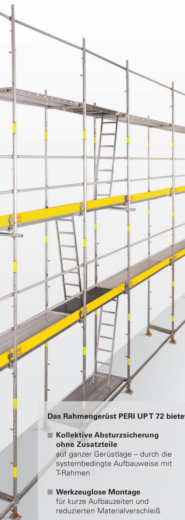
Mit PERI UP lösen Sie die täglichen Aufgaben einer Baustelle effizient. Innengeländer lassen sich jederzeit und werkzeuglos an die Stiele montieren, Diagonalen werden einfach in Aussparungen des Gerüsts eingehängt und richten es lotrecht aus. Auch die Stirnseitengeländer sind sekunden-
